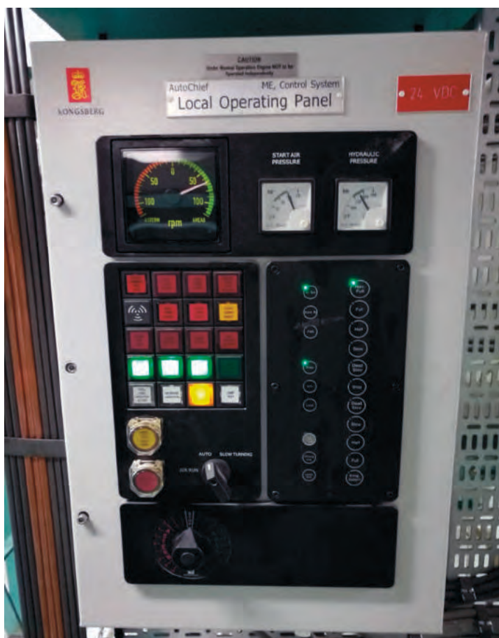
Rys. 72. Lokalny panel sterowania firmy Kongsberg silnika typu ME / Kongsberg LOP
