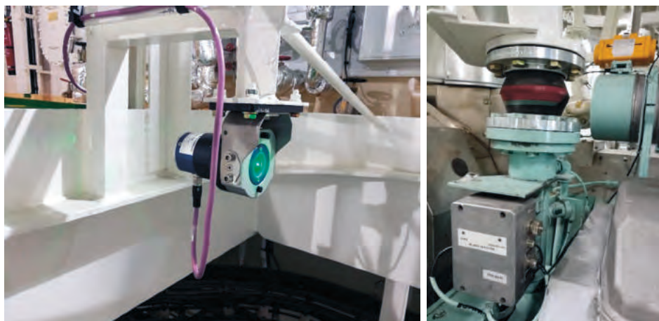
Rys. 82. Wykrywacze mgły olejowej, z lewej – atmosferyczny, z prawej – skrzyni korbowej silnika / oil mist detectors, left – ambient OMD, right – engine OMD
