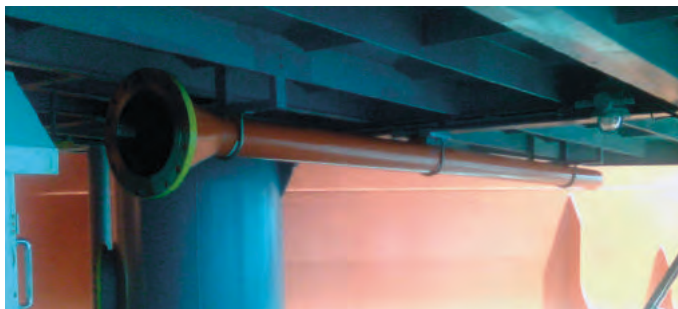
Rys. 67. Dysza do wyrzucania ładunku za burtę / jettison nozzle
