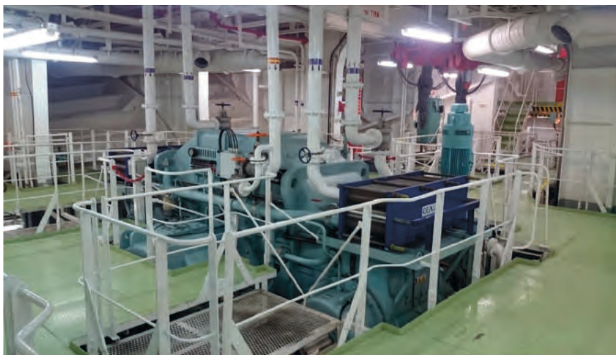
Rys. 24. Przekładnia redukcyjna napędzająca śrubę o skoku stałym statku z napędem typu DFDE / DFDE vessel reduction gear driving fixed pitch propeller
