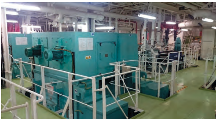
Rys. 23. Silnik elektryczny napędu statku typu DFDE / DFDE vessel main propulsion electric motor
