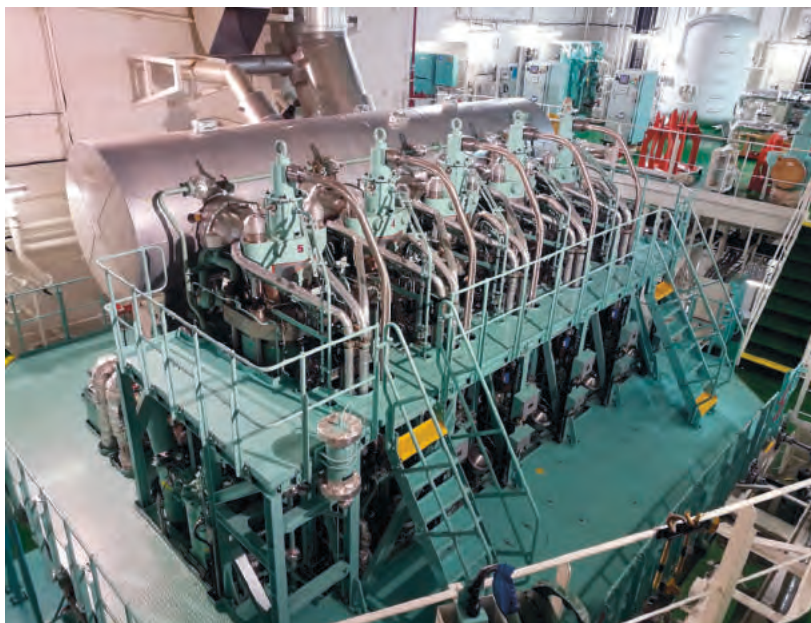
Rys. 79. Dwusuwowy wodzikowy silnik główny produkcji MAN przeznaczony do spalania gazu LNG / MEGI
