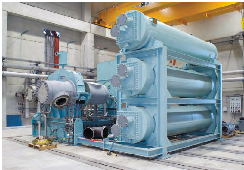
Rys. 13. Wielostopniowa sprężarko-rozprężarka z wodnymi chłodnicami firmy Cryostar / Cryostar compander [19]
