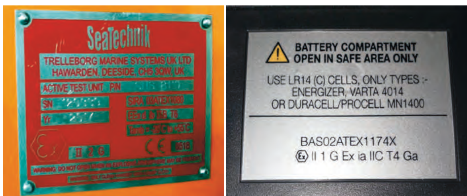
Rys. 34. Przykładowe oznaczenia Ex-proof na urządzeniach różnych producentów / examples of Ex-proof labels
