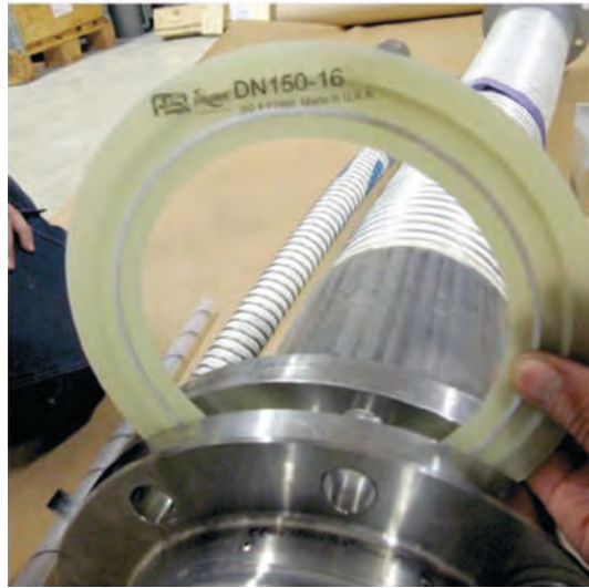
Rys. 62. Kołnierz izolujący / insulating flange [21]
