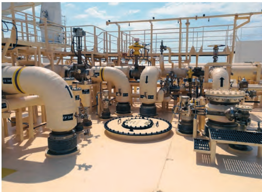
Rys. 68. Widok kopuły cieczy zbiornika ładunkowego od strony pokładu / liquid dome seen from main deck
