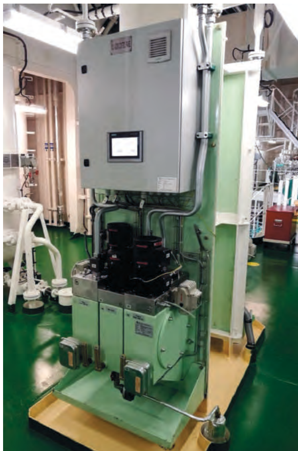
Rys. 3. Jednostka automatycznego mieszania oleju cylindrowego / ACOM unit
