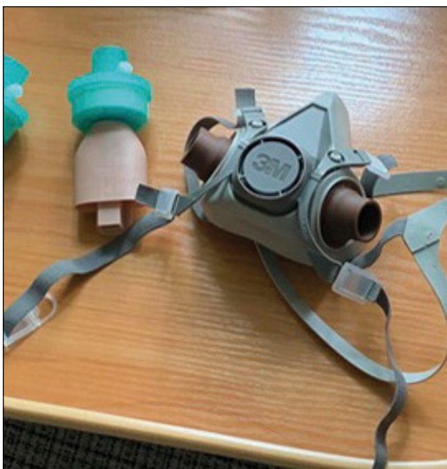
Maska 3M z zamontowanymi adapterami 3D wykonanymi przez AM
