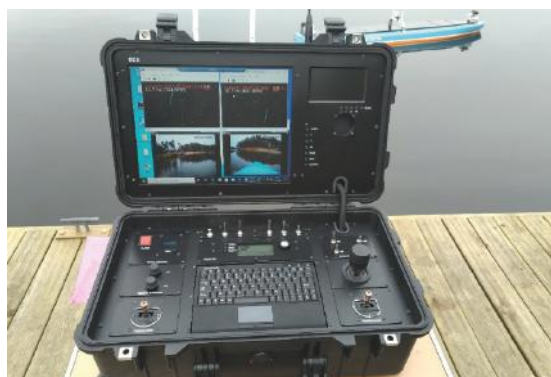
Rys. 4. Doświadczalny model bezzałogowego, autonomicznego statku transportowego z wyposażeniem nawigacyjnym – próby na otwartym akwenie (jezioro Głębokie): a) lądowa stacja kontrolna, b) model statku bezzałogowego z systemem komputerowym i wyposażeniem nawigacyjnym
