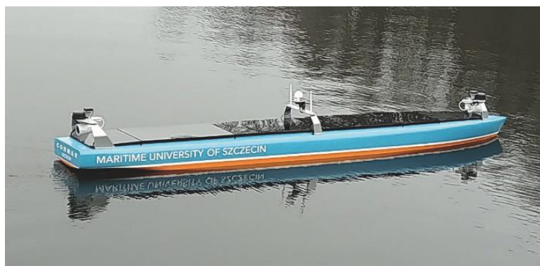
Rys. 4. Doświadczalny model bezzałogowego, autonomicznego statku transportowego z wyposażeniem nawigacyjnym – próby na otwartym akwenie (jezioro Głębokie): a) lądowa stacja kontrolna, b) model statku bezzałogowego z systemem komputerowym i wyposażeniem nawigacyjnym
