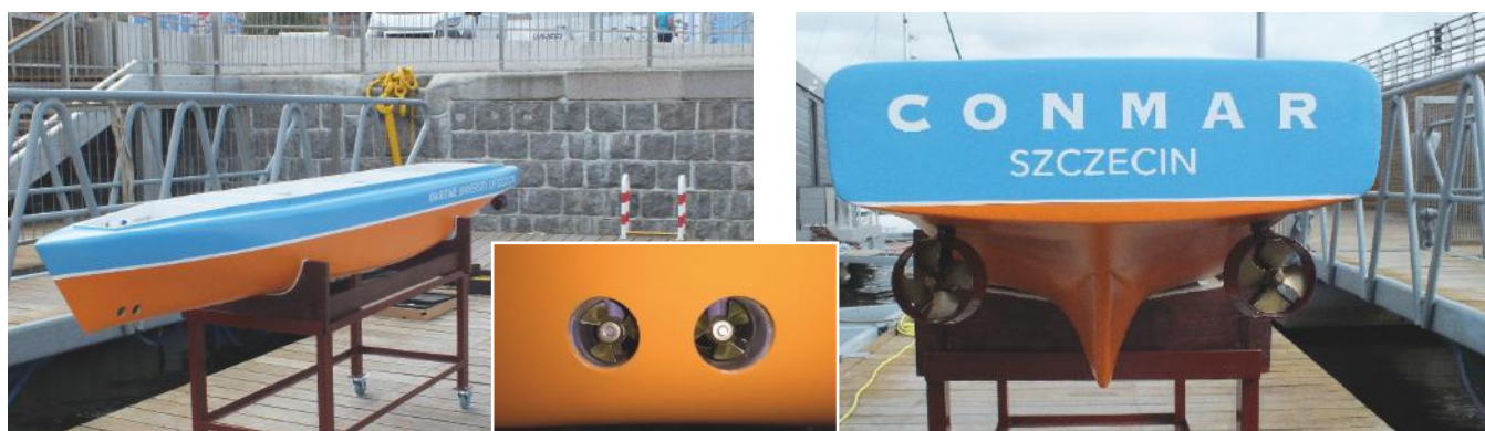
Rys. 2. Układ napędowy modelu statku bezzałogowego: rufowe pędniki azymutalne, dziobowe tunelowe stery strumieniowe
