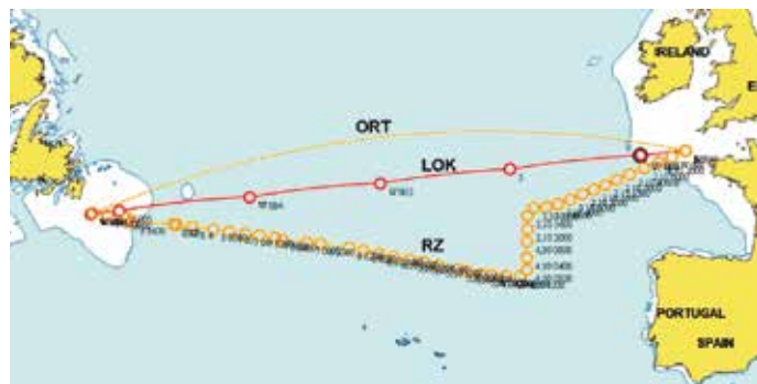
Rys. 1. Przebieg trasy zaplanowanej (LOK), rzeczywistej (RZ) i po ortodromie (ORT) (źródło: opracowano na podstawie dokumentacji statkowej)
