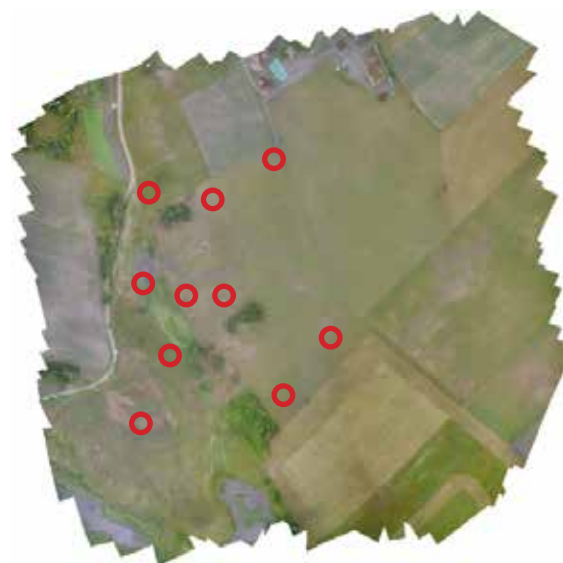
■ Po prawej – obszar objęty nalołem – ortofotomapa opracowana na podstawie ponad 300 zdjęć z systemu Sirius Pro. Rozdzielczość terenowa 3 cm. Punkty poligonu testowego zaznaczono czerwonymi kółkami
