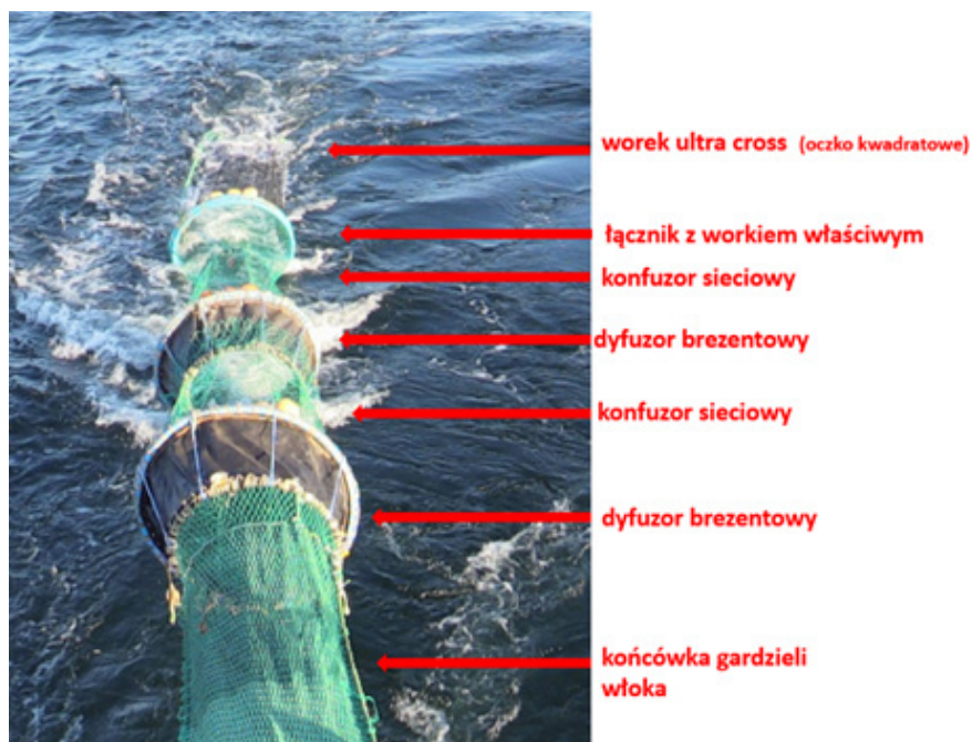
Rys. 2. Schemat innowacyjnego worka dorszowego.
